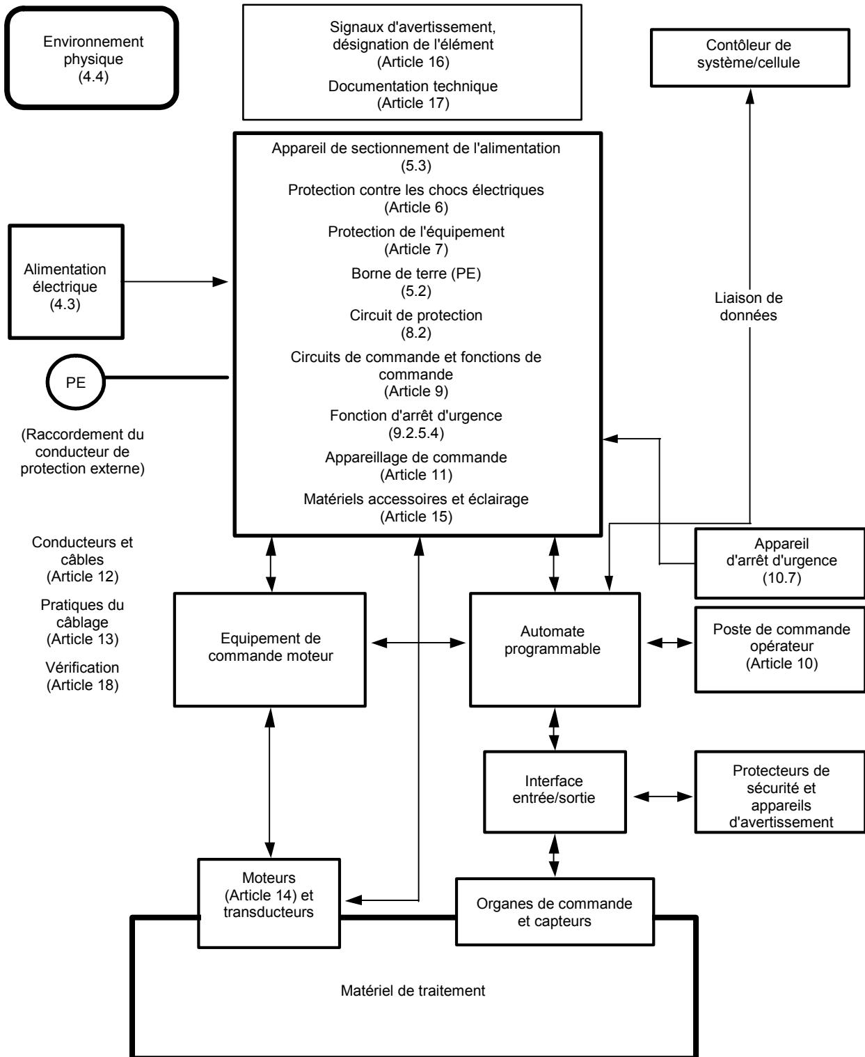
**Figure 1 – Schéma d'ensemble d'une machine type**
