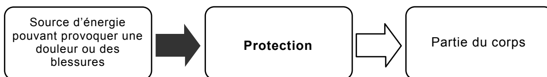
Figure 2 – Modèle en trois blocs pour la sécurité
