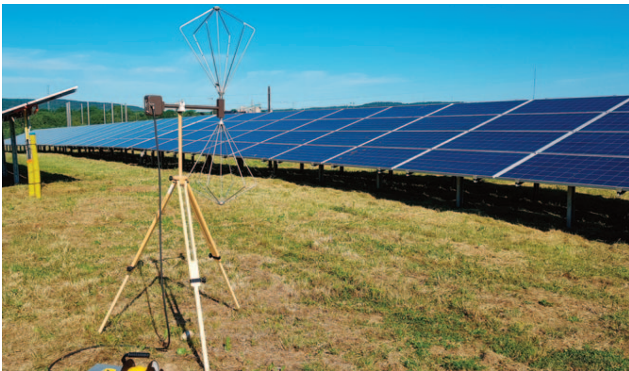
Mätning med klassisk EMC-mätantenn. Foto: Elsäkerhetsverket
